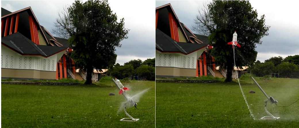
Gambar 5. Pengujian 1 roket air dengan C_g di belakang C_p saat keluar dari launcher.
