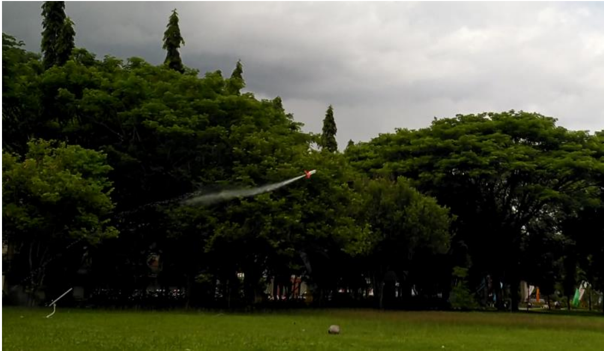
Gambar 7. Pengujian 2 roket air dengan C_g di depan C_p .
