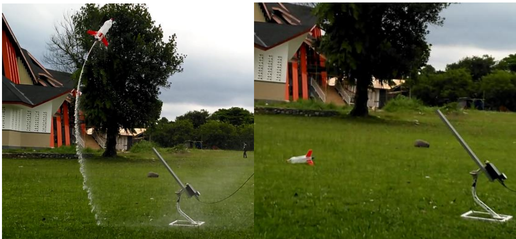
Gambar 6. Pengujian 1 roket air dengan C_g di belakang C_p setelah keluar dari launcher.
