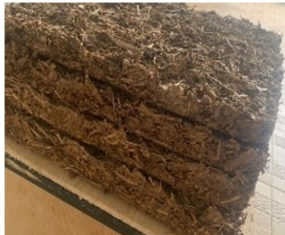
**Gambar 2. pelepah batang pisang 50% rak telur 50% ketebalan 5 cm.**
