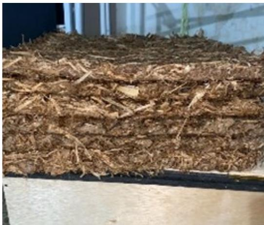
**Gambar 1. pelepah batang pisang 50% rak telur 50% ketebalan 3 cm**
