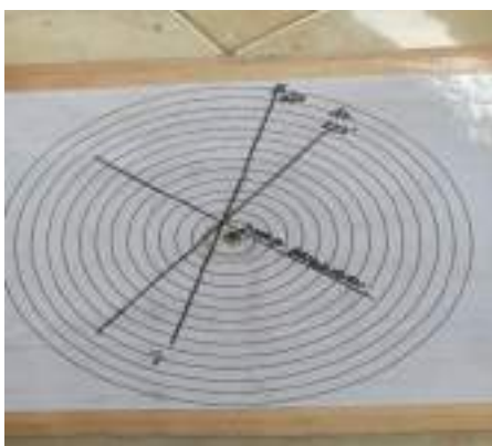
Gambar 7.3 (Hasil Pengukuran arah kiblat menggunakan metode tongkat istiwa)
