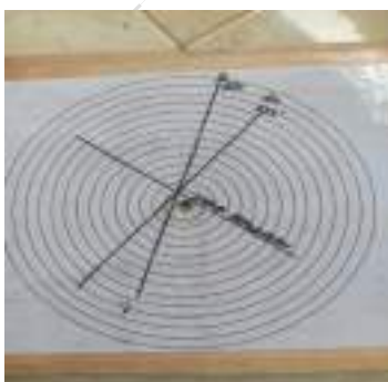
Gambar 12.3 (hasil pengukuran arah kiblat menggunakan metode tongkat istiwa)
