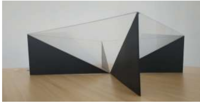
Gambar 2 Piramida Reflektor yang dibuat sesuai rancangan dengan bahan akrilik
