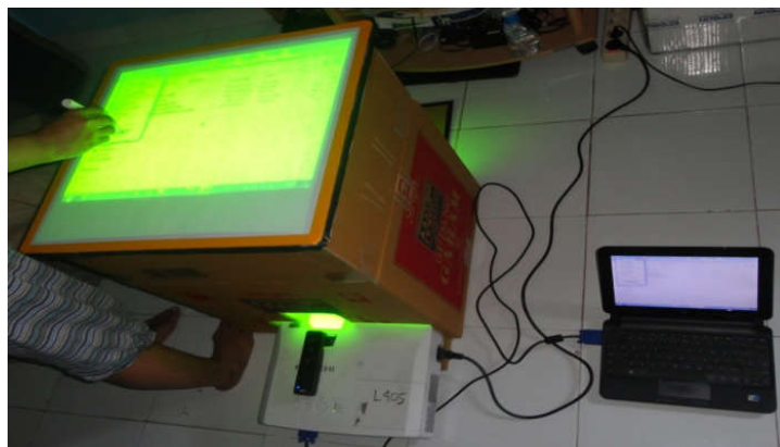
Gambar 4.4 Wiimote whiteboard menggunakan box sebagai media layar
