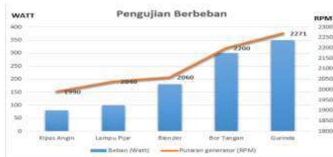
Gambar 7. Pengujian Berbeban Genset Biogas Pada beberapa Mesin Elektronik
