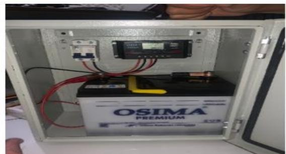
Gambar II.3 Modul Instrument Penerangan Lampu Jalan
