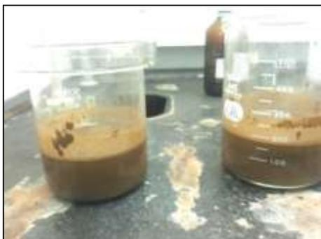
**Gambar 1** Perendaman abu terbang (*fly ash*) dengan asam klorida (HCl)
