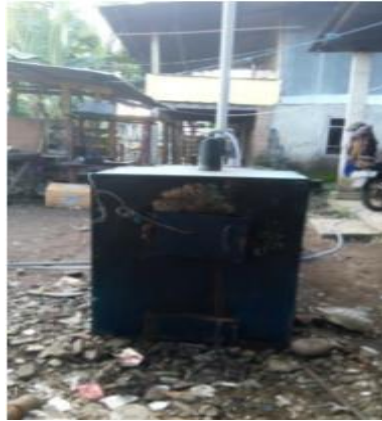
Gambar 4 Hasil rancang alat insinerator dua tahap
