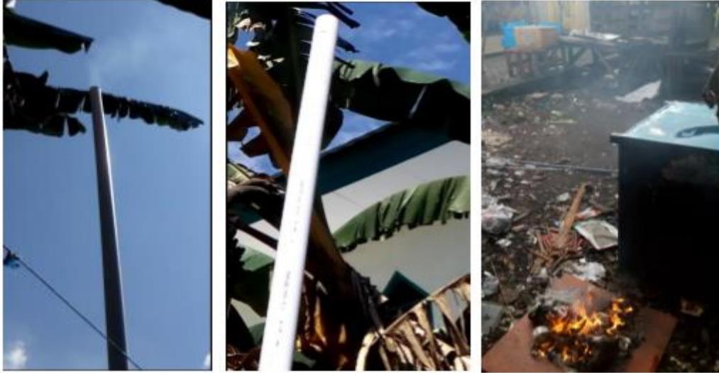
Gambar 8 Hasil keluaran asap pada pipa pembuangan (a) tanpa filter air (b) dengan filter air (c) pada pembakaran bebas
