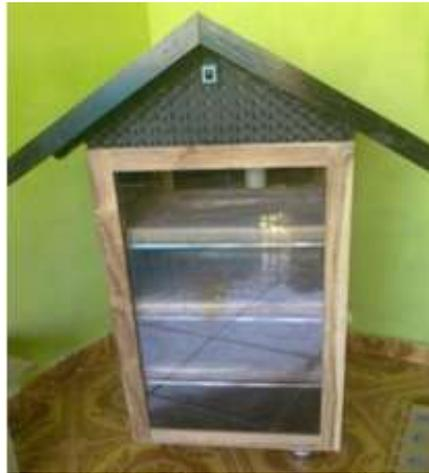
Gambar 4. Hasil rancangan alat pengering tipe rak menggunakan kolektor surya
