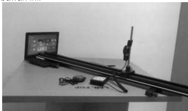
Gambar 1. Pengukuran tingkat iluminasi pada laptop
