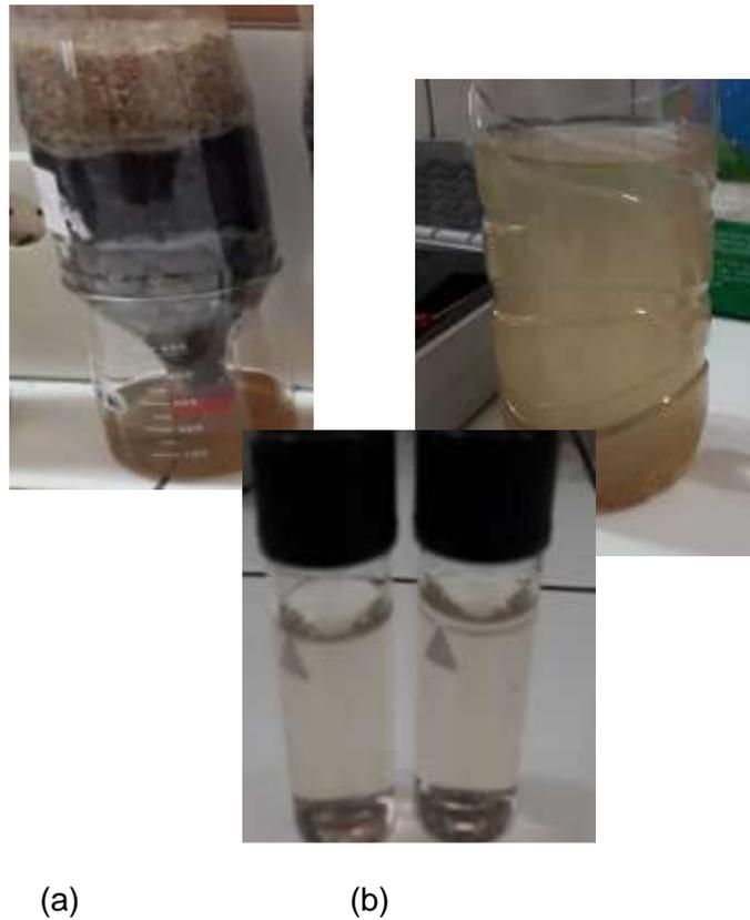
**Gambar 6** (a) simulasi filter (b) sampel sebelum penyaringan; (c) hasil penyaringan sampel (a) (Sumber: Dokumentasi Pribadi).
