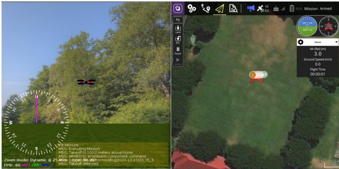
Gambar 5. Simulasi 1, Take-off dan landing otomatis dengan bagian kiri merupakan software jMAVSim dan bagian kanan adalah QGroundControl
