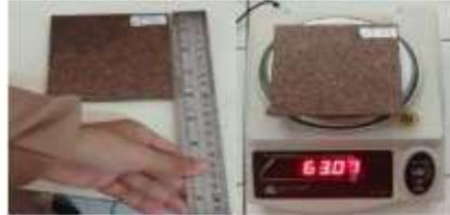
Gambar 3. Pengukuran dimensi panjang dan massa sampel untuk uji kerapatan (*density*)
