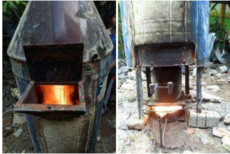
Gambar 4. Proses pembakaran sampah menggunakan insinerator.
