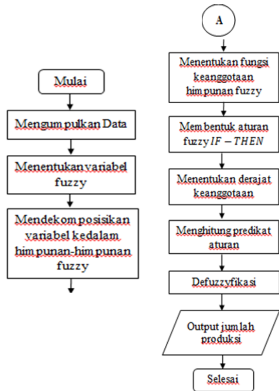
Gambar 3.1 Diagram Alur FIS Metode Sugeno dalam menentukan Jumlah produksi paving blok
