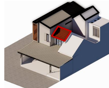
Gambar 13. 3D skematik bangunan eksisting (pasca redesign )—sisi hadap atas (atap) yang mengalami proses heat transfer radiasi paling besar Sumber: Dokumentasi prbadi, 2022
