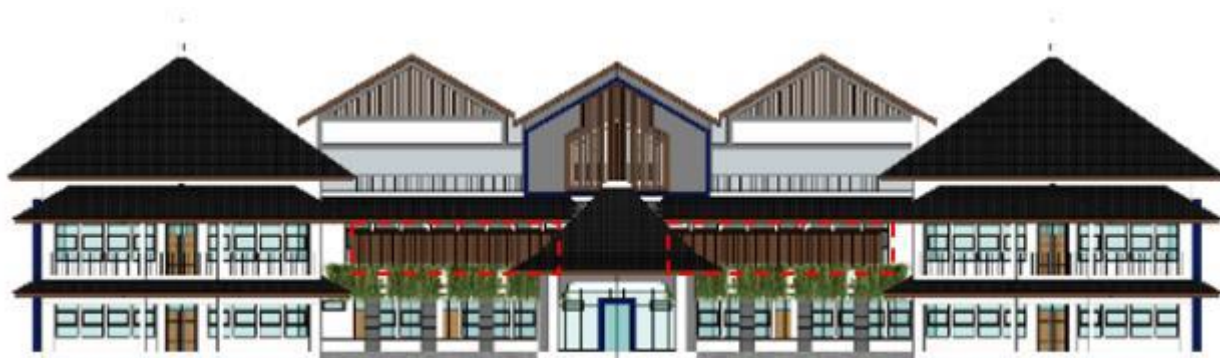
Gambar 9. Penempatan secondary skin pada fasad
