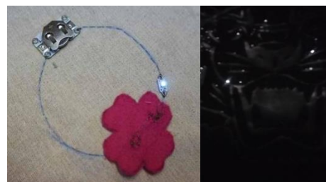
Gambar 4. Tekstile Circuit pada Kain Sircuit efek timbul cahaya
