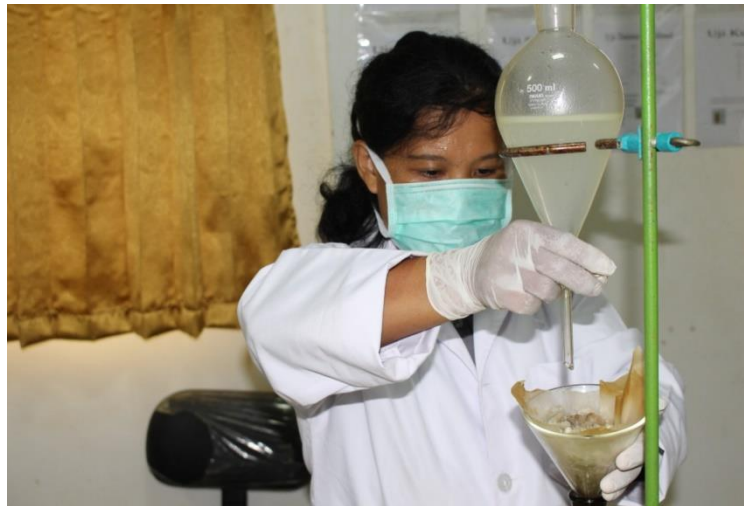
Gambar 1. Proses pemurnian minyak atsiri menggunakan corong pisah
