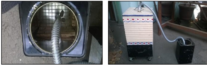
Gambar 7. Dry Leaves Cremation Processor dengan penampung asap
