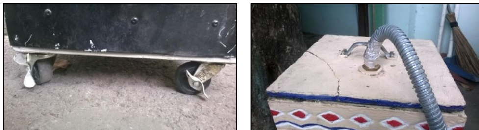
Gambar 6. Penambahan roda pada Dry Leaves Cremation Processor
