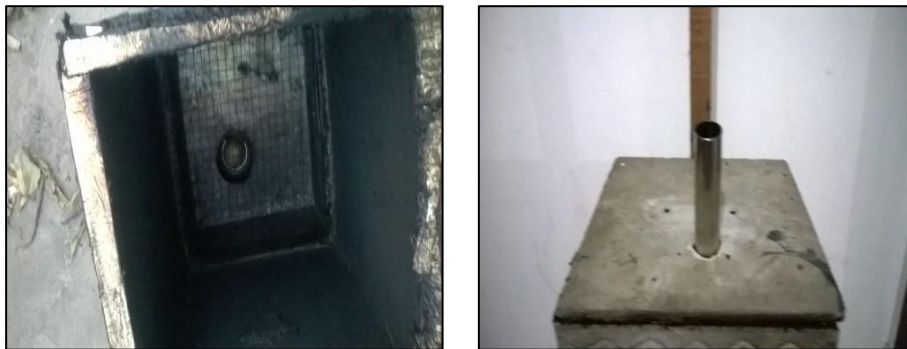
Gambar 5. Jaring-jaring dalam Dry Leaves Cremation Processor
