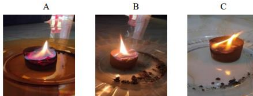
Gambar .3 Pengujian lama pembakaran setiap komposisi biobriket
