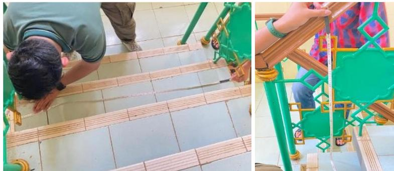
Gambar 7. Dokumentasi Ukuran Lebar Tangga & *Handrail*
