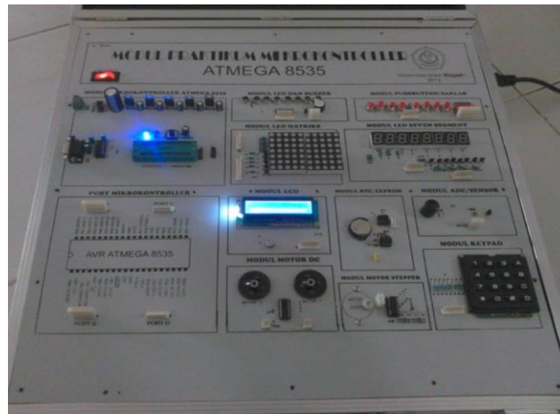
Gambar 8. Tampilan Modul Mikrokontroler ATmega8535 Saat Merespon Tegangan dari Catu Daya
