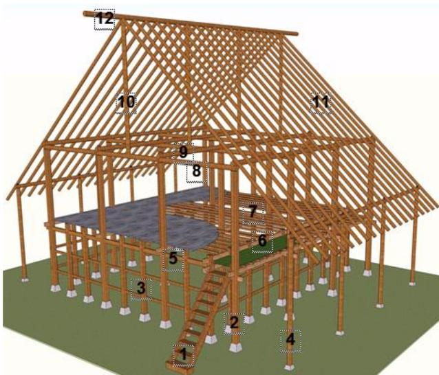
**Gambar 3. Struktur dan konstruksi rumah Duri asli**
