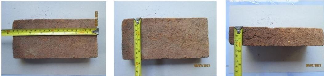
**Gambar:** Pengukuran panjang, lebar dan tebal batu bata merah
