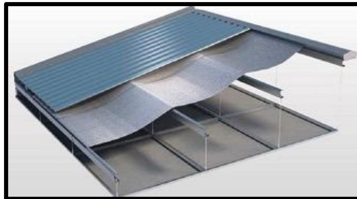
Gambar 6. Pemasangan Aluminium Foil Pada Atap Sumber: https://bajaringansystem.com
