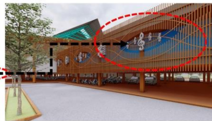
Penggunaan secondary skin pada fasad bangunan mengambil dari bentuk daun dan garis melengkung sebagai estetika dan filter agar cahaya yang berlebihan tidak langsung masuk ke dalam bangunan.
